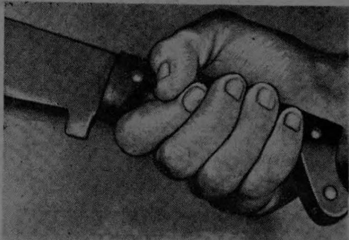
El grabado muestra claramente un machete de trabajo dotado de una "espiga" protectora. Este nuevo modelo, especialmente construido para los trabajadores de la zona bananera, se ha confeccionado con el objeto de evitar que la mano mojada, ya sea por agua o sudor, resbale sobre el mango, cortando la mano del trabajador que lo maneja.
